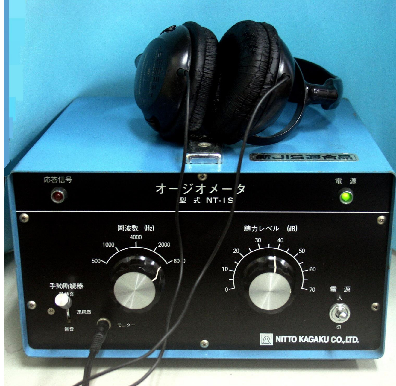
新JIS規格適合品のオーディオメータ（聴力計）
